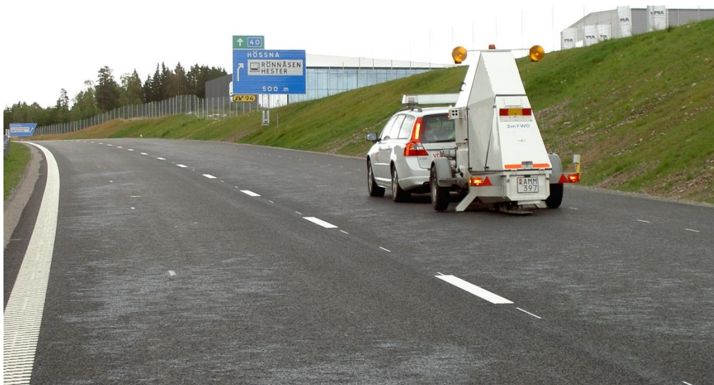
Figur 1. Fallviktsmätning på färdig väg på Rv40 Ulricehamn
